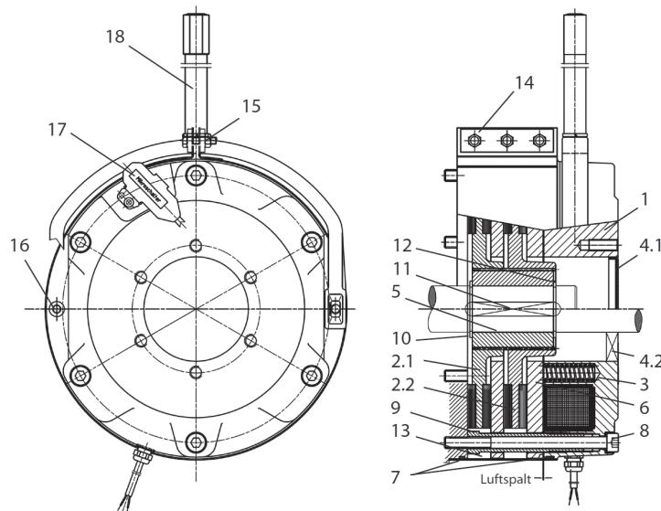
Рисунок 2. Устройство тормоза ZS(X)
