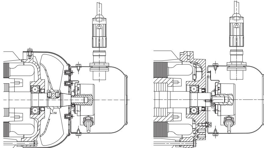
Двигатель, тормоз и датчик
