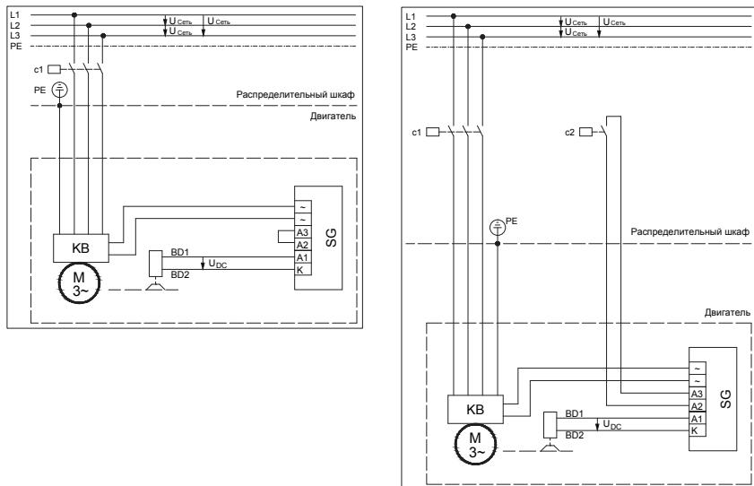
"Питание выпрямителя от клеммника электродвигателя или клеммного блока KB (см. раздел ""Подключение выпрямителя к клеммнику двигателя или клеммному блоку KB""")"
