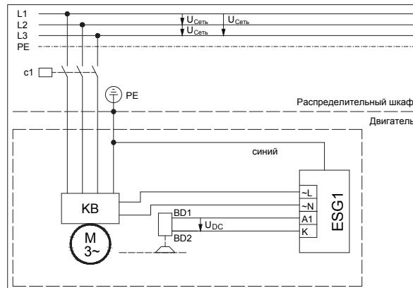
"Питание выпрямителя от клеммника электродвигателя или клеммному блоку KB (см. раздел ""Подключение выпрямителя к клеммнику двигателя или клеммному блоку KB""")
