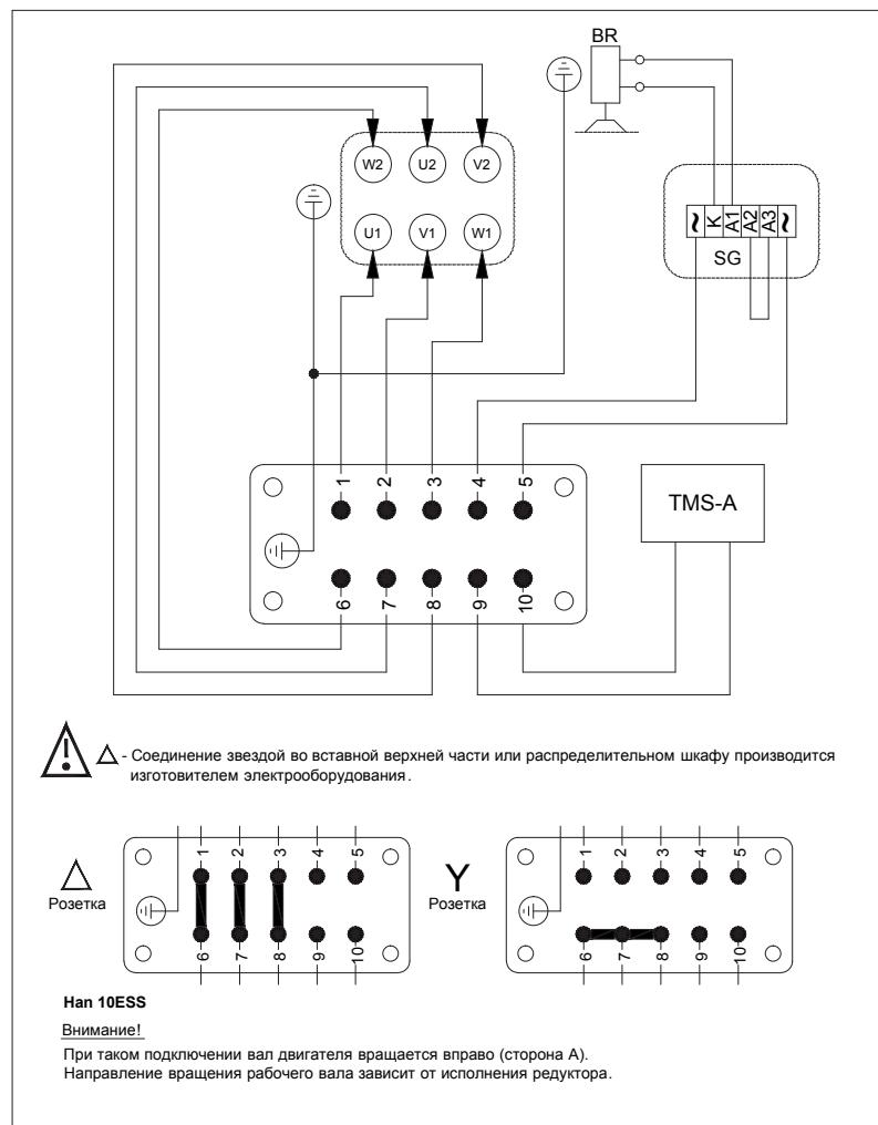
Альтернативно двигатели могут поставляться с круглым штекером, который монтируется на заводе в стандартную клеммную коробку и также подходит для подключения тормозов, термисторов и термостатов. Просим направлять запросы.
